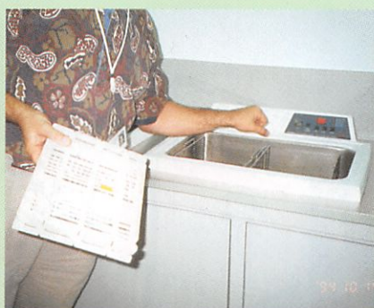
図2 超音波洗浄器(器具を専用ケースに入れたまま超音波洗浄する)
