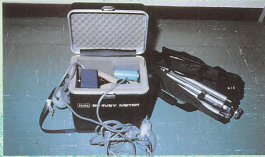
図14 奥尻町での検査終了後に改良した歯科用X線撮影装置 ヘッド、アダプター、タイマー、延長コードが格納されている。三脚はストラップ付き専用ケースに収納されている。
