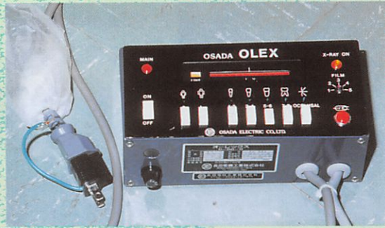
図15 タイマーと電源部プラグ コードについているビニールは、電源部を雨、埃等から保護するために、コンセントに差し込んだらこれを裏返してプラグを被覆し、必要に応じてビニールテープ等でコンセント部に貼りつける。
