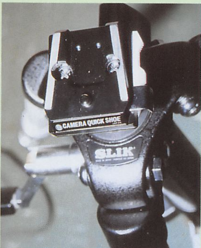
図18 三脚エレベーター上端部に固定したクイックシュー
