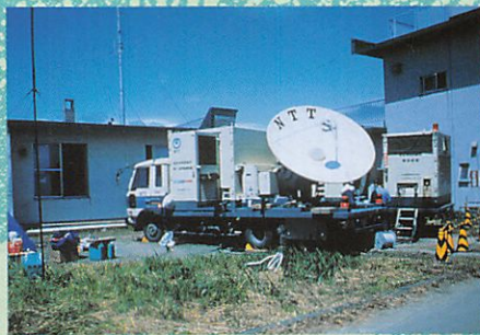
図5 奥尻町に設置されたNTT衛星通信車載局
